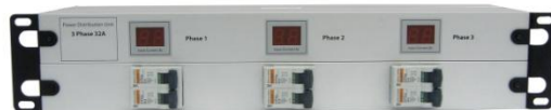
Regleta 2 U 3 x 32A 12 Schukos con 3 amperímetros 32A y 6 magneto-térmicos 16A. PDU 2 U 3 x 32A 12 Schukos with 3 current meters 32A & 6 MCB's 16A. Regleta 2 U 3 x 32A 12 IEC-320 C19 con 3 amperímetros 32A y 6 magneto-térmicos 16A. PDU 2 U 3 x 32A 12 IEC-320 C19 with 3 current meters 32A & 6 MCB's 16A.
