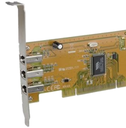
Adaptador PCI 3 x IEEE 1394a (FireWire 400) - ECO. PCI Adapter, 3 x IEEE 1394a (FireWire 400) Ports - ECO.
