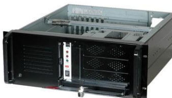
Chasis industrial para montaje en rack, Negro - ECO. 4U Industrial Rack-Mount Server Chassis – ECO.
